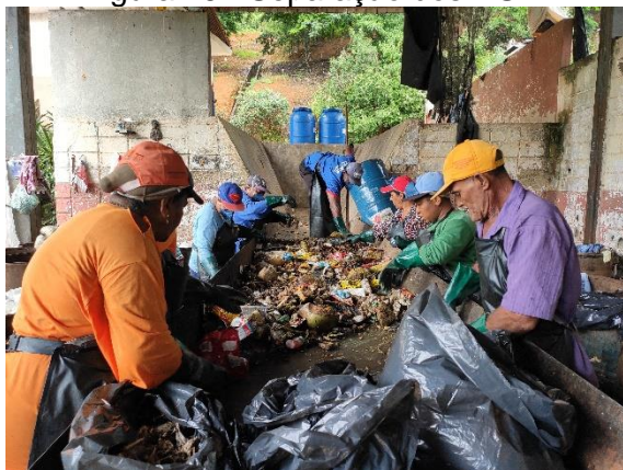
Figura 16 - Separação dos RSD.
