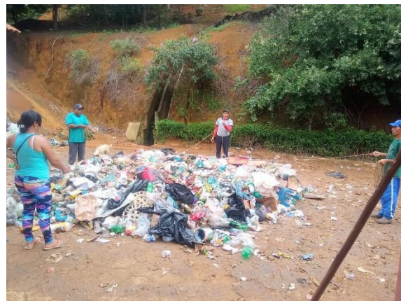
Figura 12 – Quarteamento das amostras.
