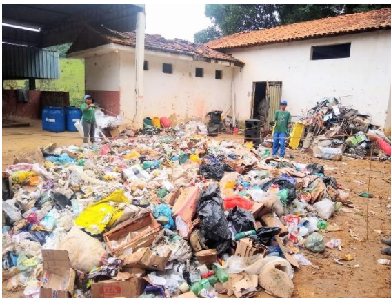
Figura 11 – Quarteamento das amostras.
