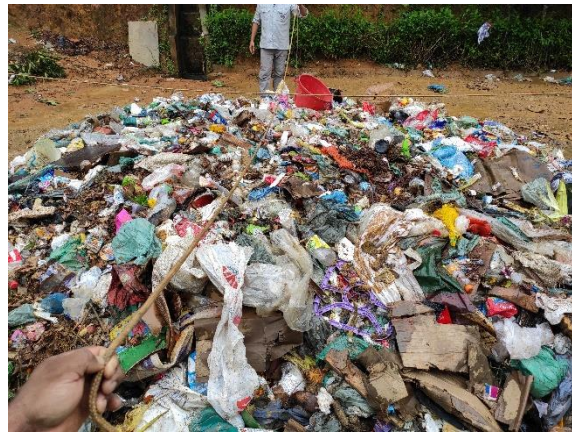
Figura 10 – Quarteamento das amostras
