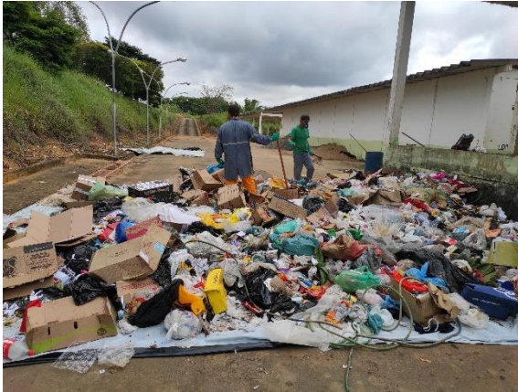
Figura 09 – Quarteamento das amostras.
