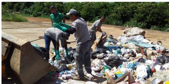
Figura 05 – Quarteamento das amostras.
