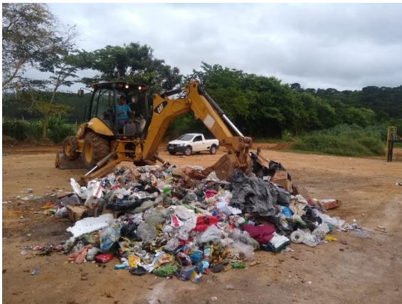
Figura 05 – Quarteamento das amostras.
