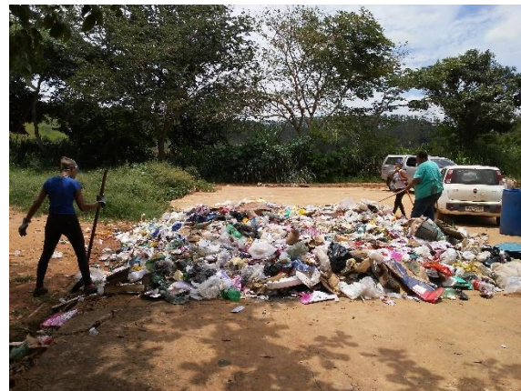
Figura 10 – Quarteamento das amostras.
