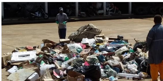
Figura 05 – Quarteamento das amostras.
