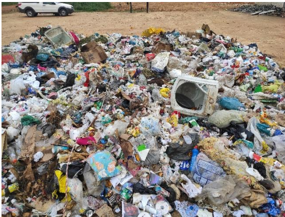
Figura 09 – Quarteamento das amostras.
