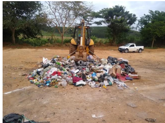
Figura 06 – Quarteamento das amostras.
