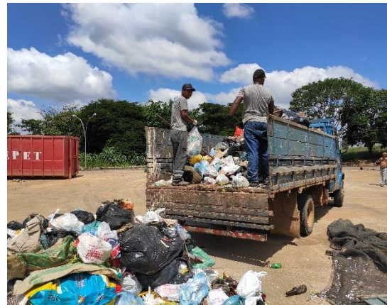
Figura 04 – Quarteamento das amostras.
