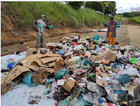
Figura 11 – Quarteamento das amostras.
