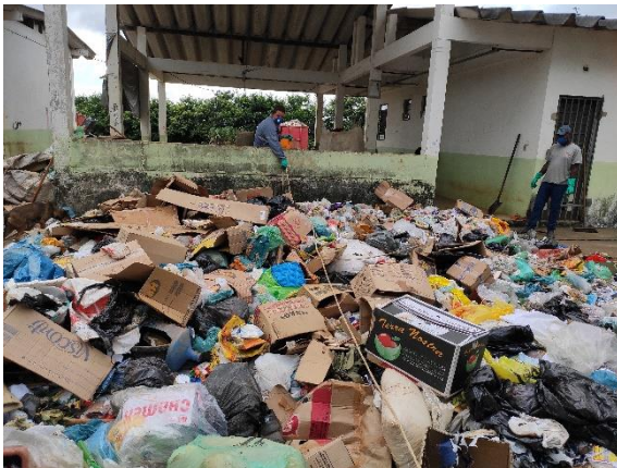
Figura 11 – Quarteamento das amostras.
