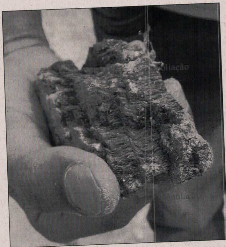
Foto 4.5- Detalhe da amostra de mão do filito exibindo o plano da foliação principal crenulado.
