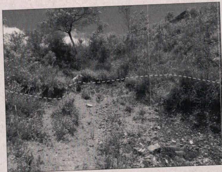
Foto 7: Vista geral do provável contato entre o aterro sob o qual a escola foi implantada e o filito da Formação Cercadinho.
