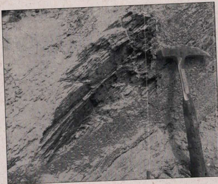
Foto 4.2- Detalhe do filito apresentando cor cinza a cinza prateado, elevado grau de alteração (A4) e resistência muito branda inferior (R1-).
