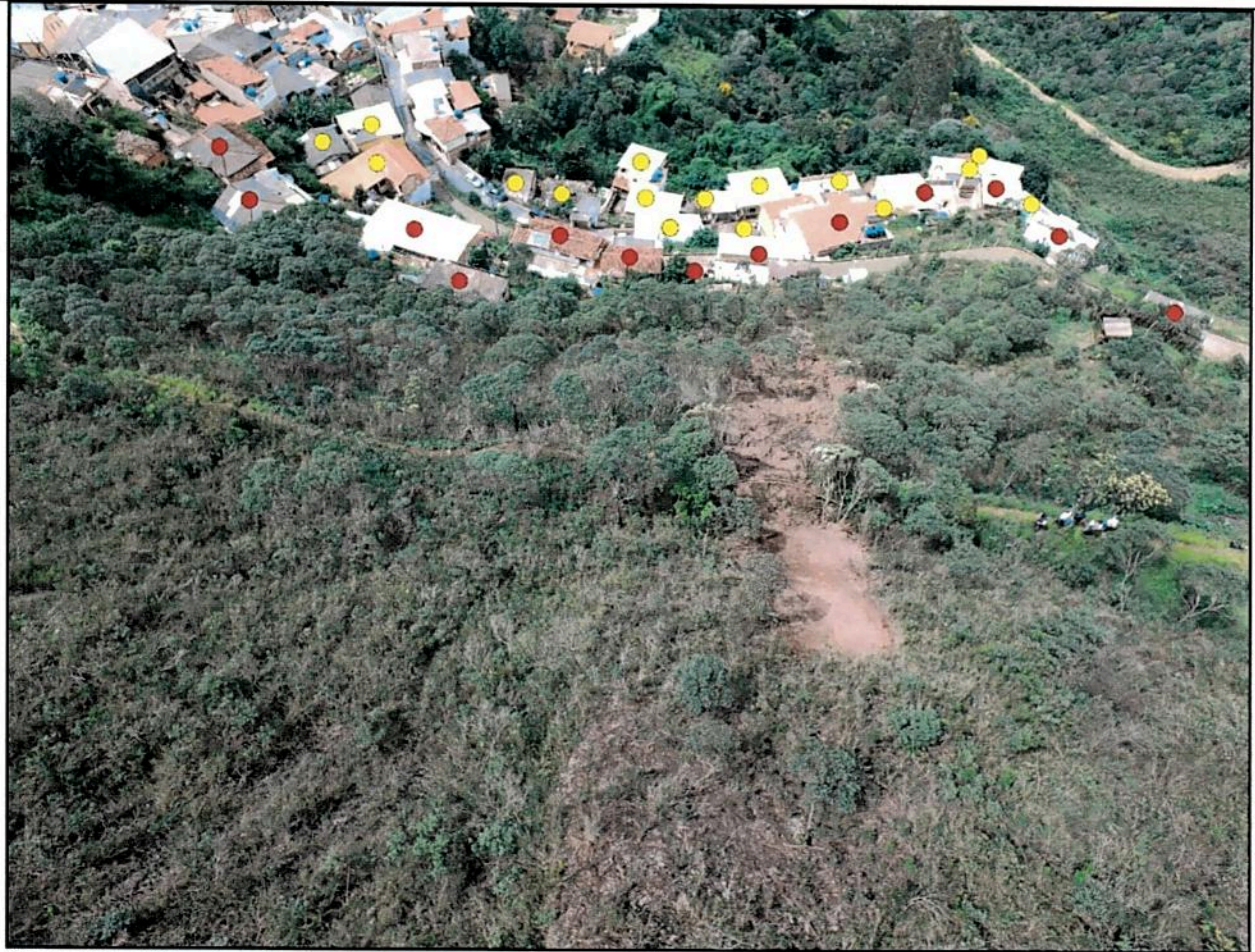
Figura 22 – Vista aérea da cicatriz de ruptura para jusante tirada com o auxílio do drone. As residências abaixo marcadas com círculo vermelho indicam que estão em rota de colisão direta dos detritos provenientes de um futuro deslocamento em um movimento de massa planar. As residências com círculo amarelo estão em rota de colisão indireta dos detritos do deslizamento. Ao todo se somam 29 residências com aproximadamente 116 pessoas estimadas. Ressalta-se que havendo um movimento de massa com grandes magnitudes, à semelhança daquele que ocorreu na encosta que deslizou sobre o Terminal Rodoviário em 2012, o número de residências e pessoas atingidas poderia ser muito maior do que o número aqui apresentado. Autor: Charles Romazâmu Murta. Local: Rua Pirita, Bairro São Cristóvão; Data: 13/01/2018.
