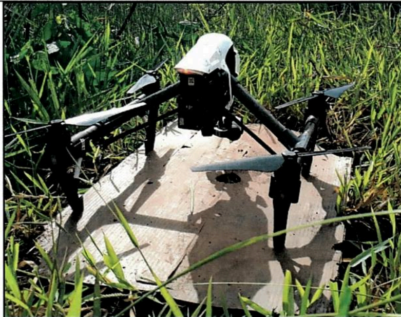
Figura 17 – Drone profissional modelo "Inspire 1" utilizado para composição de imagens da encosta. O objetivo foi identificar novas fraturas abertas que apresentem o mesmo risco potencial deflagrador de futuros movimentos de massa do tipo planar. Esse drone, portando uma câmera com alta resolução de imagens, foi gentilmente emprestado pela empresa PCP Engenharia. Autor: Charles Romazâmu Murta. Local: Rua Pirita, Bairro São Cristóvão; Data: 13/01/2018.
